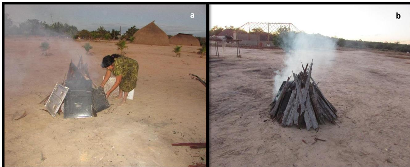
Figura 34. Processo de queimação das cerâmicas. a) forno feito de alumínio; b) forno feito de casca de árvores. Foto: Hukai Waura.
